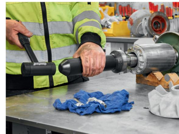
装拆工具FT 33保证安装应力被均匀施加在轴承内外圈上, 避免被施加在滚动体上
