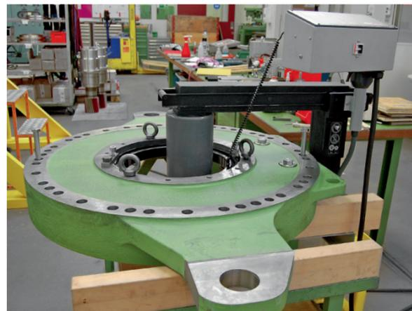
最大和最有效的森马电磁感应加热器IH 240被用于风力发电机齿轮箱法兰的加热。
