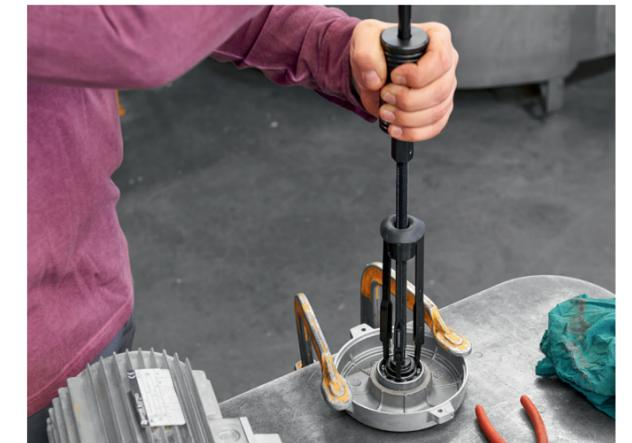
维护箱MK 10-30使得球轴承可以轻松从电动机端盖上被拆卸
