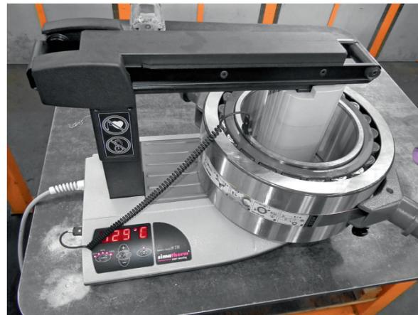
放置在IH 210线圈周围的滚动轴承正在被电磁感应加热。一旦设定的安装温度到达,使用轴承上的森马夹持工具可以轻松移动调整轴承在轴上的位置。
