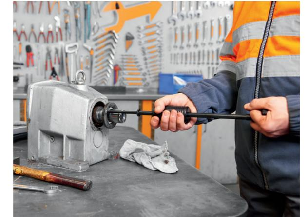
诀窍: 使用密封件拆卸器SP 50从齿轮箱上拆卸径向密封件, 不会伤害外壳或轴
