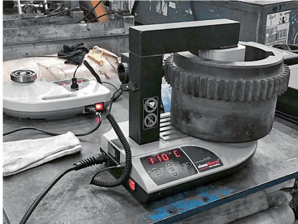
森马电磁感应加热器VOLCANO IH025和IH070加热两种不同尺寸的工件：型号IH070（前方）加热一个齿轮套到特定的安装温度。
