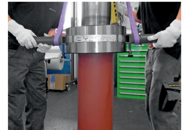
轴承夹持工具BHT能够将沉重、预加热过的滚动轴承安全地提升并精确地定位到涡轮轴上
